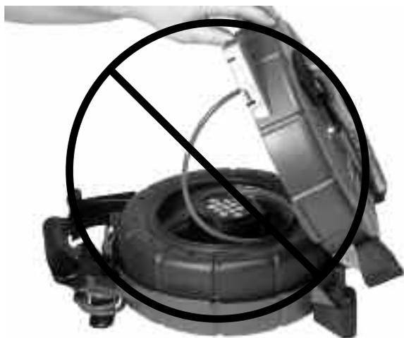
**Рис. 10 – Не допускайте самопроизвольного разматывания кабеля**
