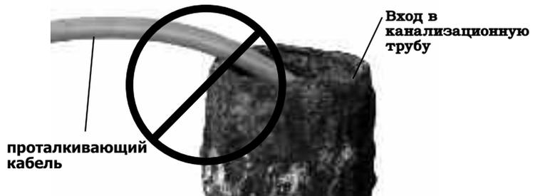
**Рис. 23 – Не следует вытягивать кабель по острым кромкам**
