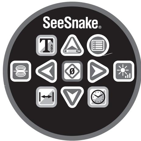
Рис. 20 – Дополнительная клавиатура CountPlus
