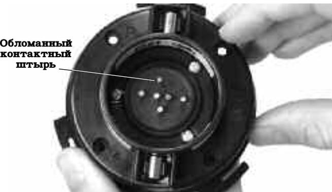
**Рис. 12 – Обломанный контактный штырь**
