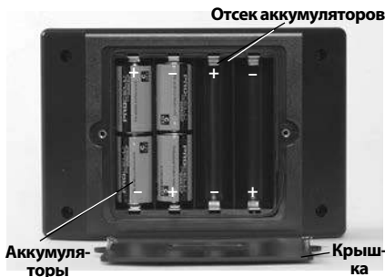
Рис. 6 – Замена аккумуляторов (передатчик)
