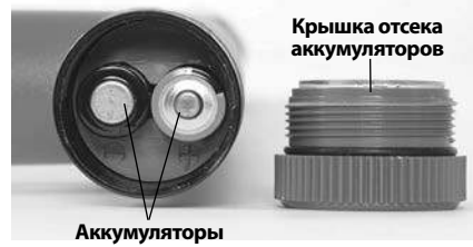
Рис. 7 – Замена аккумуляторов (приемник)
