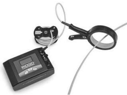
Рис. 14 – Индукционные клещи, подсоединенные к токопроводу
