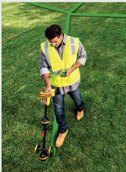
Можно использовать трассоискатель SR-24 для беспроводного изменения частоты генератора ST-33Q+.
