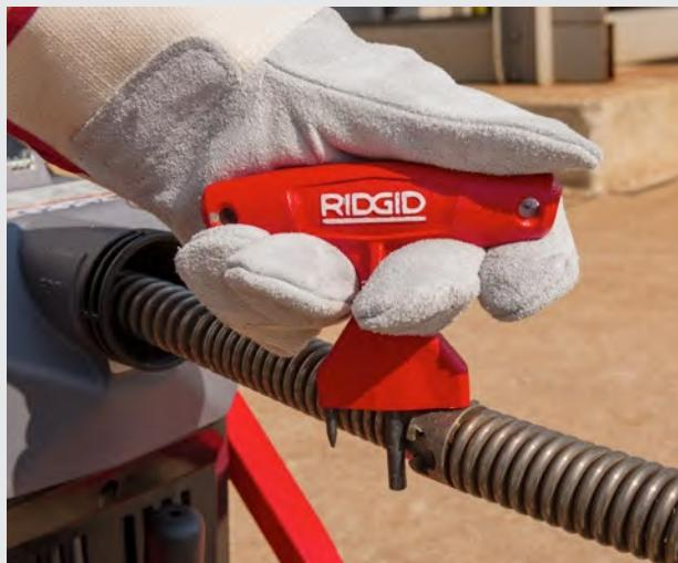
Легкое и быстрое разъединение кабелей и инструментов при помощи трезубца-разъединителя спиралей
