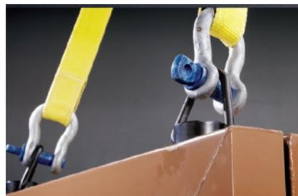
Четырёхточечная крановая подъёмная система с использованием среднеточечного такелажа способствует более безопасному / брусовой подъёмной системой и обеспечивает грузоподъёмность при общей массе 1.100 кг.
