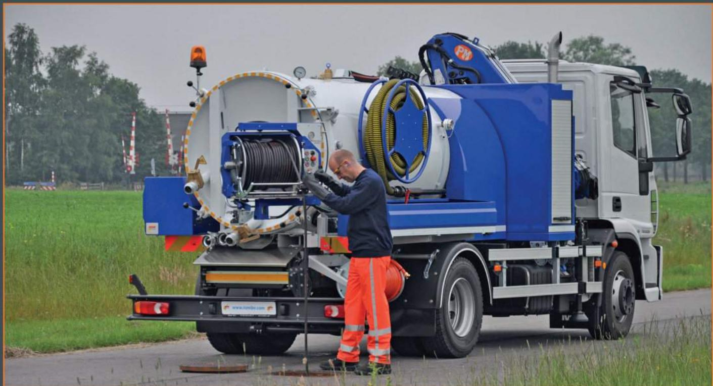
ROM SmartCombi PRO - старший брат нашего SmartCombi и предназначен для автомобилей от 6 тонн. Помимо дополнительной силы вакуумного всасывания и увеличенной промывной и очистной способности PRO также вмещает в себя множество дополнений и доступен в РТО и дизельной версии.
