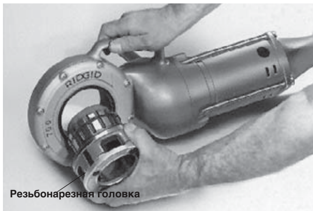
Рисунок 3 – Установка головки № 12-R с откидным верхом
