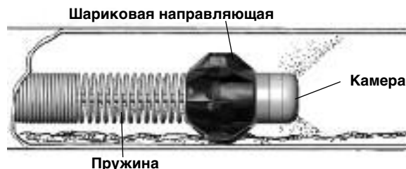
Рис. 12. Шариковая направляющая в использовании
