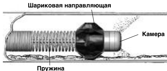
Рис. 19. Шариковая направляющая в использовании
