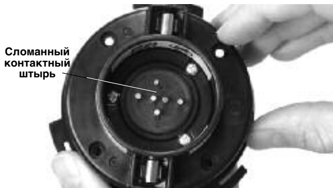
Рис. 7. Сломанный контактный штырь
