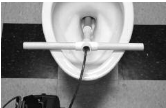
Рис. 24. Использование направляющей трубы из поливинилхлорида
