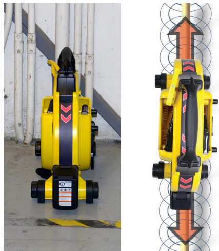
Рисунок 4 — Индукция с помощью RIDGID SeekTech ST-33Q+
