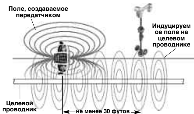
Рис. 15 – при индукционном режиме необходимо находиться не менее чем в 30 футах (10 м) от передатчика для обеспечения обнаружения целевого проводника.
