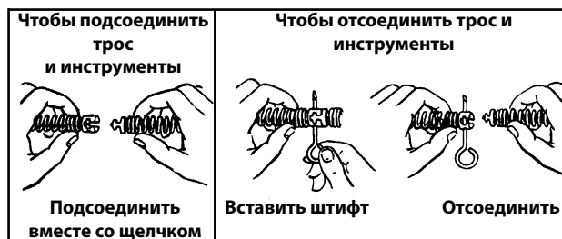
Рис. 1: Соединение и разъединение тросов и инструментов
