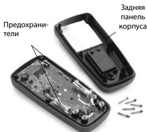
Рис. 9 – Снятие задней панели корпуса
