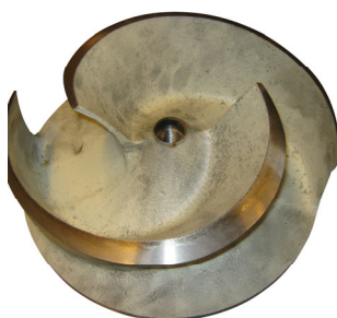
Рабочее колесо полуоткрытого типа Нержавеющий и абразивноустойчивый сплав легир. стали (42CrM04).
