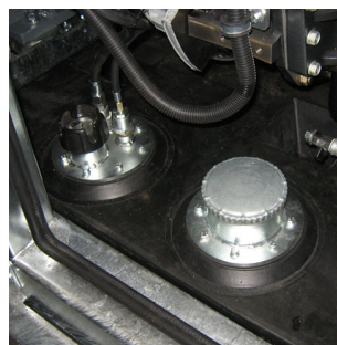
Топливный бак С защитой от протечек, нержавеющей, 300 л, композитный (HDPE), расположен на основе корпуса.
